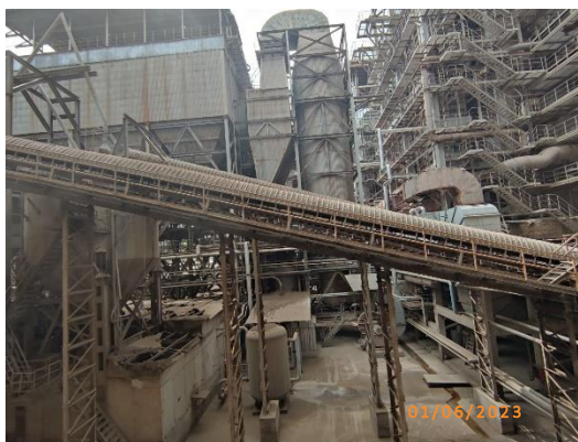
รูปที่ 2-5 Drag chain ลำเลียงฝุ่นจาก Dust Settling Chamber ในระบบปิด
